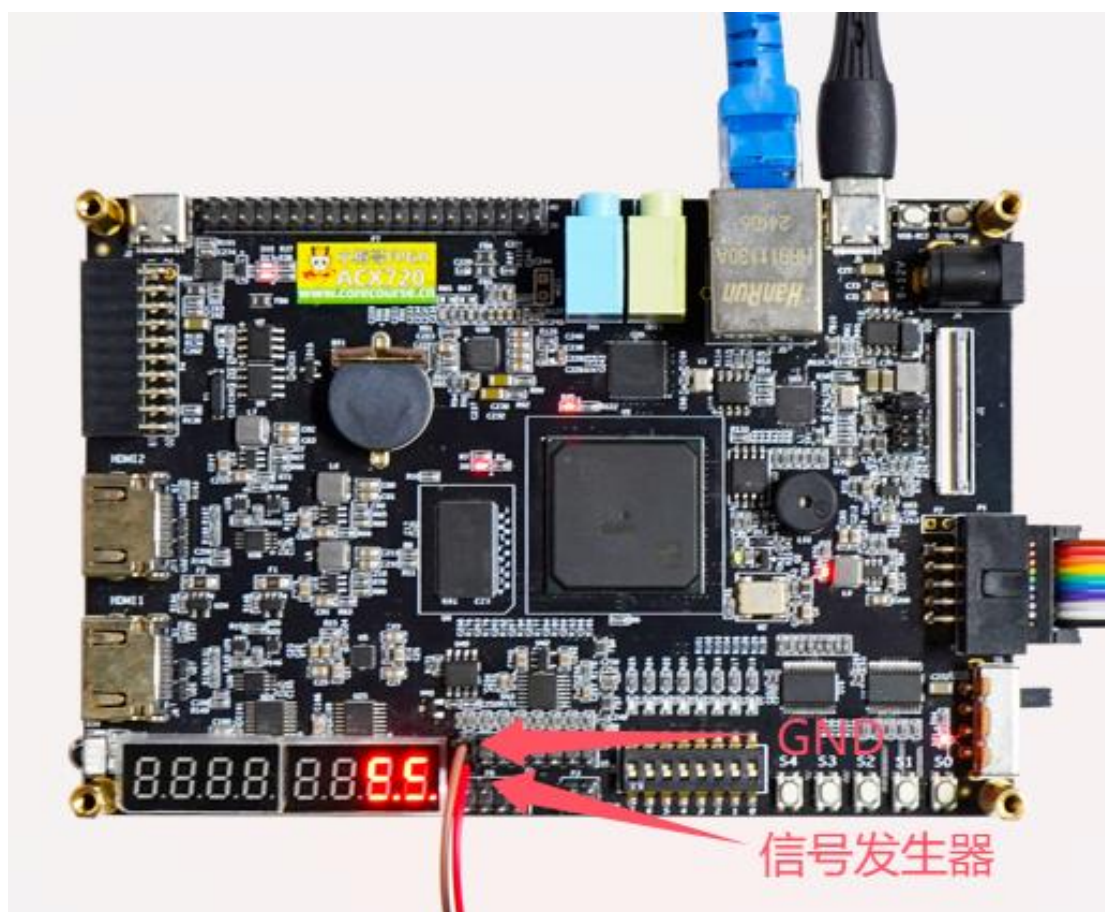
图 45 ACX720 硬件连接图
