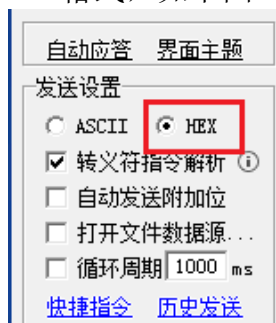
图 1-57 设置发送格式为 hex 码格式
