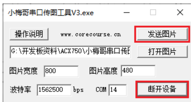
图 1-12 设置完图片信息后向对应的 com 端口号发送图片
